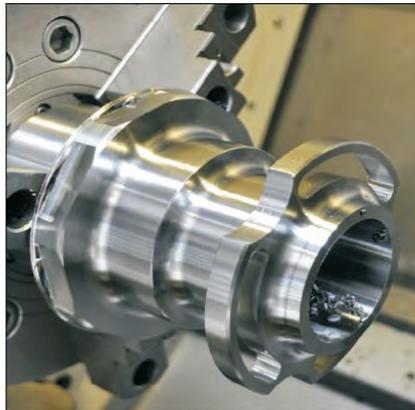
Bearbeitung von Vollschnitten (Hochgeschwindigkeitsbearbeitung)
